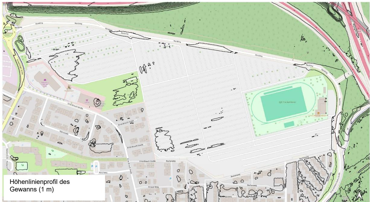
Das Gelände weist keine wesentlichen Differenzen in Bezug auf die Höhenlagen auf. Das gewählte Höhenlinienprofil beträgt 1 Meter. Die gemittelte Höhe des Areals beträgt ca. 102,5 Meter über Normal Null (NN). Der Bezugspunkt für die Höhenermittlung ist entsprechend passend gewählt.
